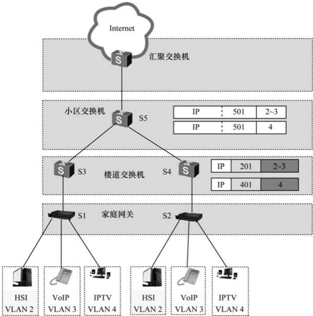
图7-21 2 to 1的VLAN映射应用示例
