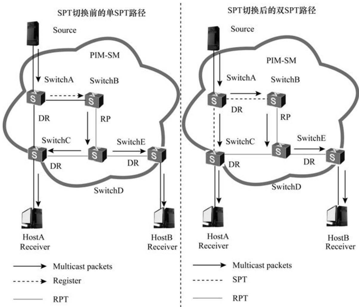
图13-6 ASM模型SPT切换前后对比示意图
