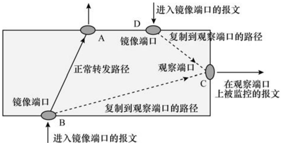
图14-2 N：1镜像示意图
