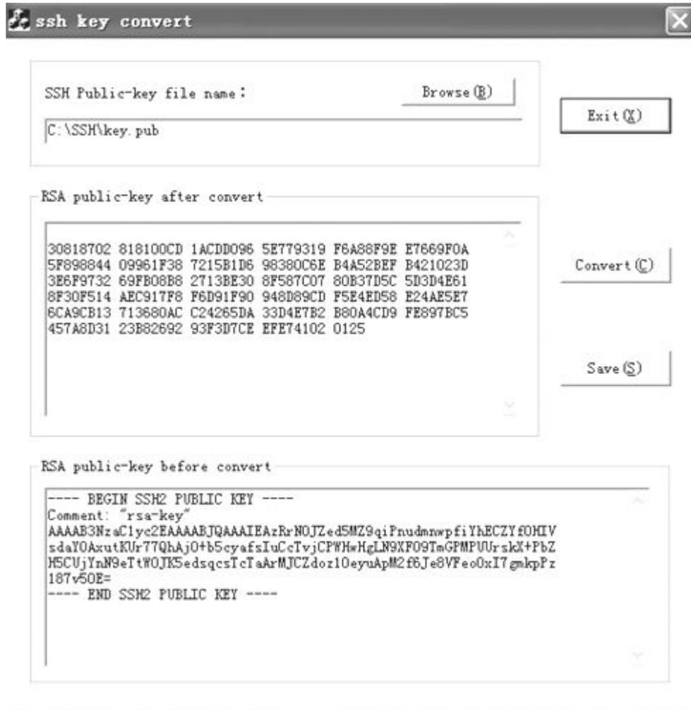
图3-15 生成公钥后的SSH密钥转换对话框
