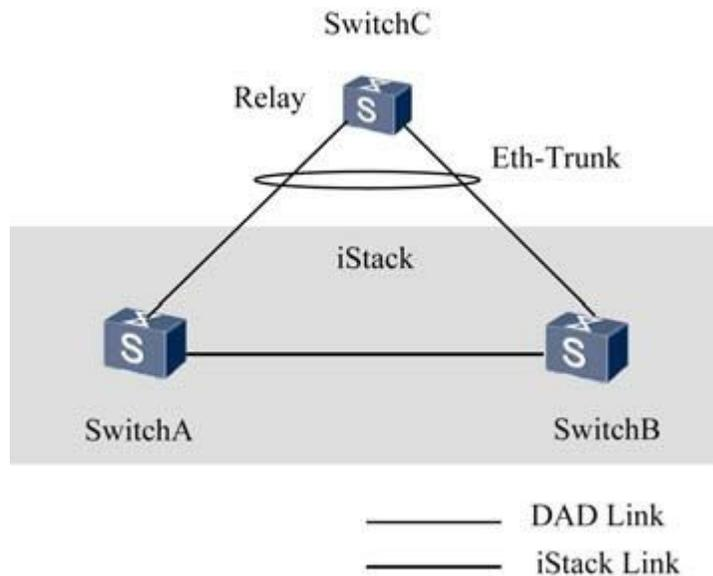
图5-8 Relay代理方式双主检测示意图
