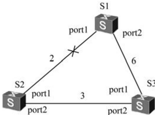
图8-19 对次优BPDU处理的示例图二
