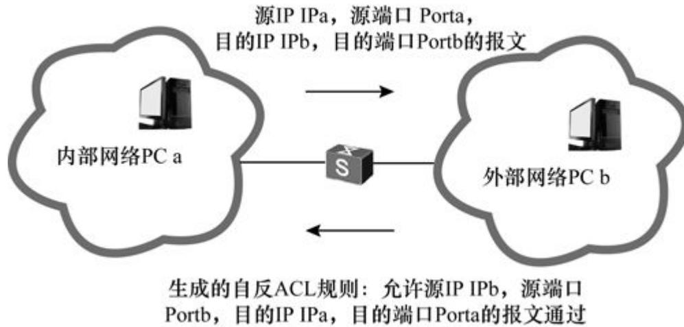
图9-5 自反ACL工作原理示例
