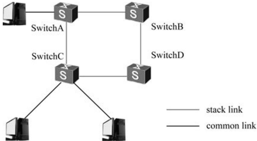
图5-4 iStack堆叠环形拓扑结构
