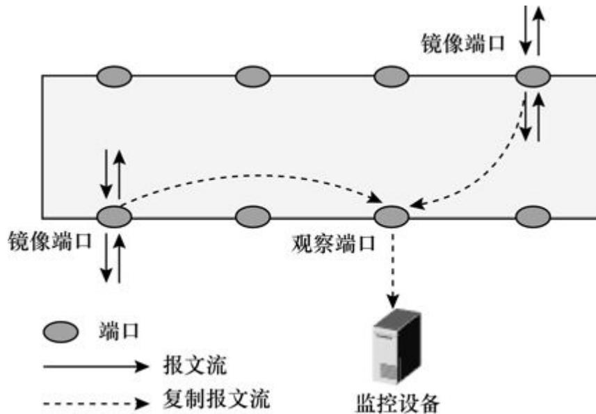
图14-3 端口镜像示意图
