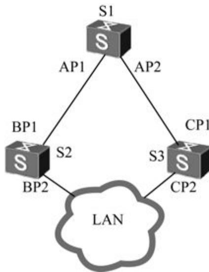
图8-2 环形网络结构示例
