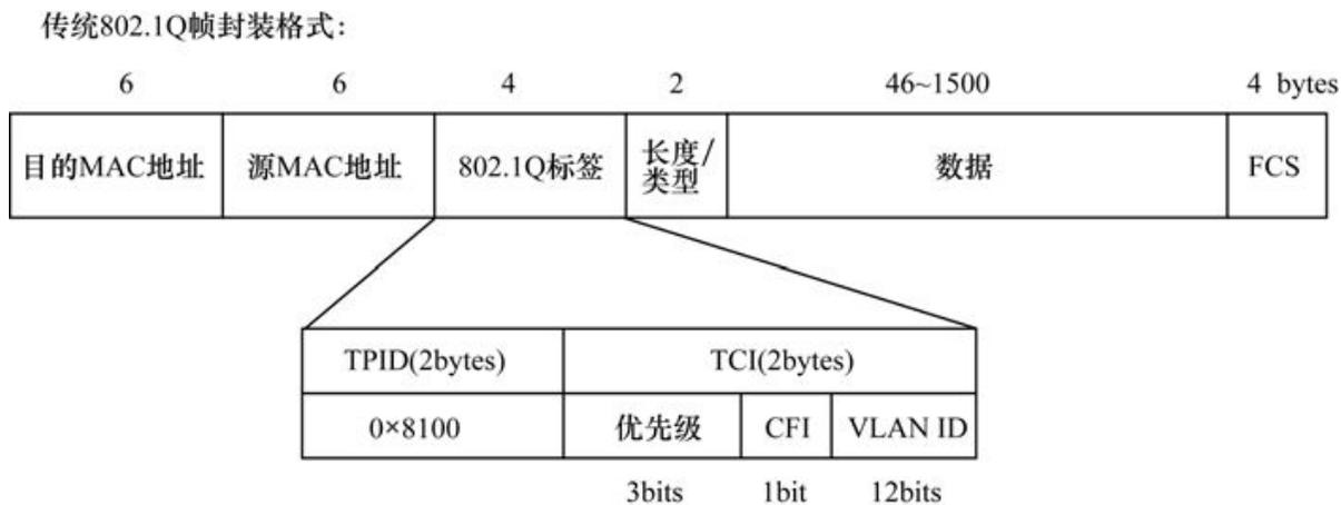
图7-15 VLAN帧中的TPID字段
