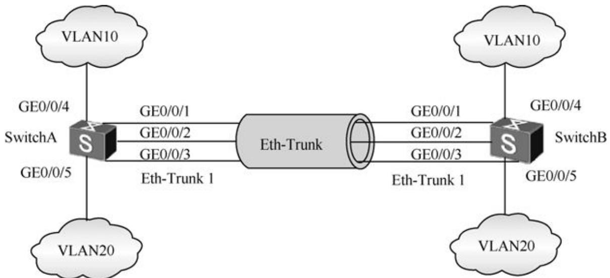
图4-7 手工负载分担模式链路聚合配置示例拓扑结构
