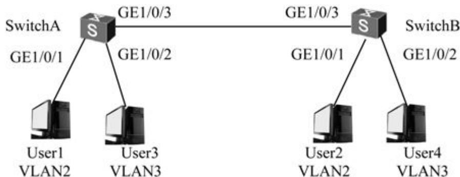
图6-7 基于接口划分VLAN示例拓扑结构
