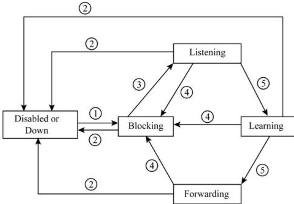
图8-7 端口状态迁移示意图
