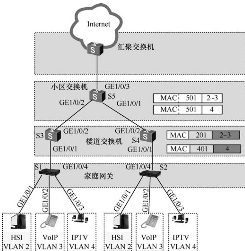
图7-24 基于VLAN的2 to 1的VLAN映射配置示例的拓扑结构
