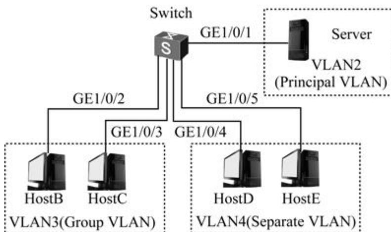
图7-10 MUX VLAN配置示例拓扑结构
