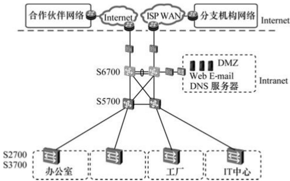
图1-19 S6700系列交换机在大型网络中的应用示例
