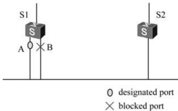
图8-6 根据PID选择指定端口的示例
