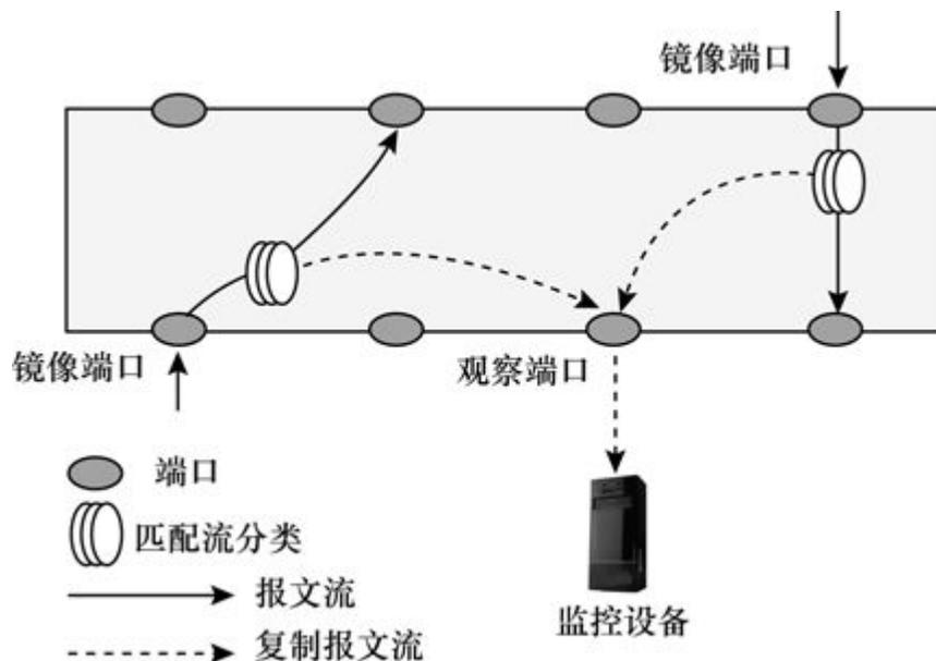
图14-7 流镜像示意图
