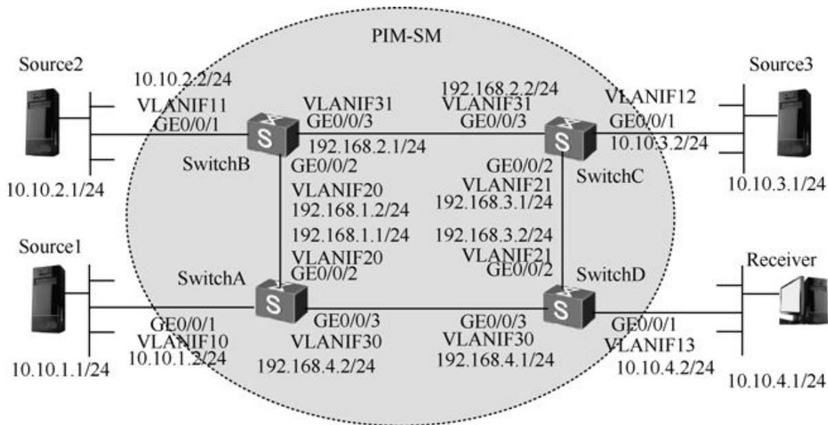
图13-3 SSM Mapping配置示例拓扑结构
