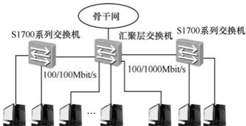
图1-8 S1700系列的企业园区网的接入层应用示例
