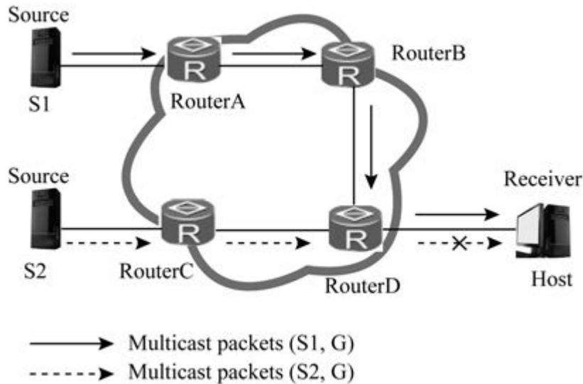
图12-13 特定源组的组播源过滤示意图
