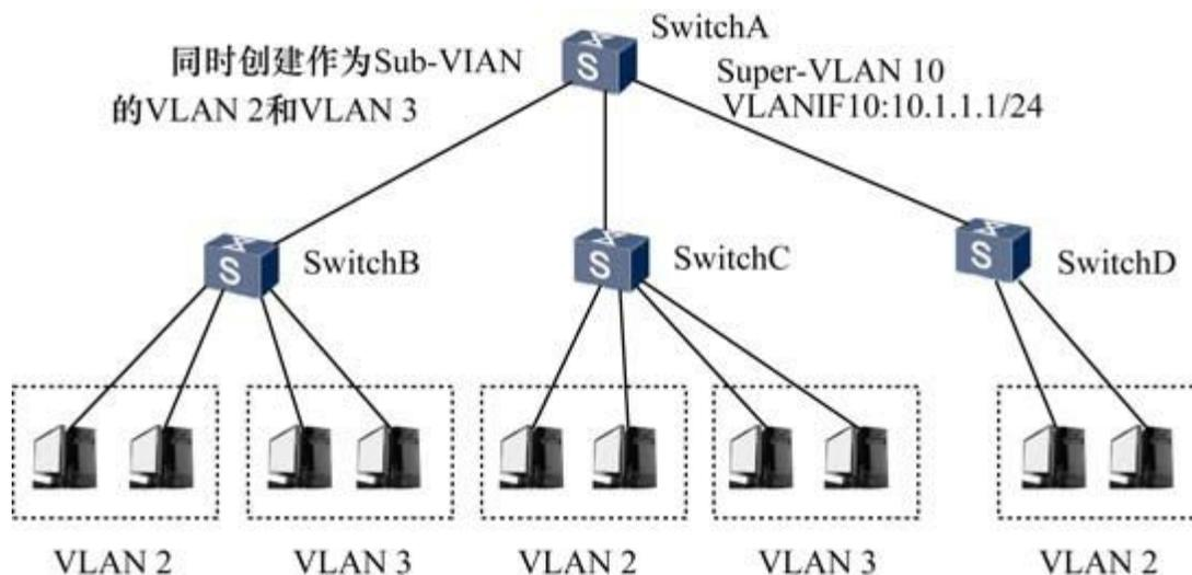
图7-8 跨交换机的VLAN聚合示例
