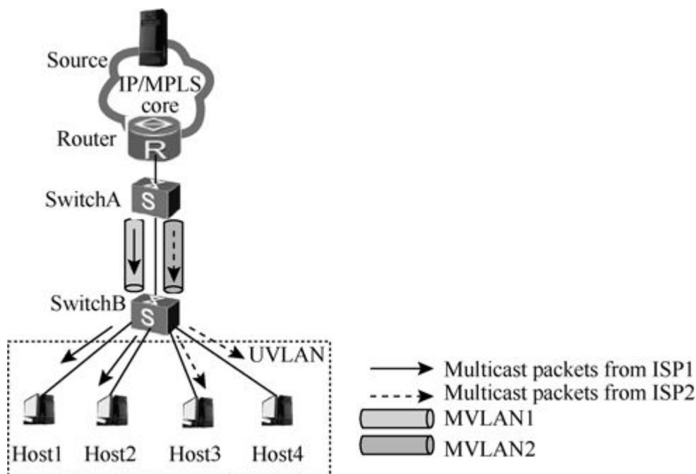
图12-43 基于接口的组播VLAN示例
