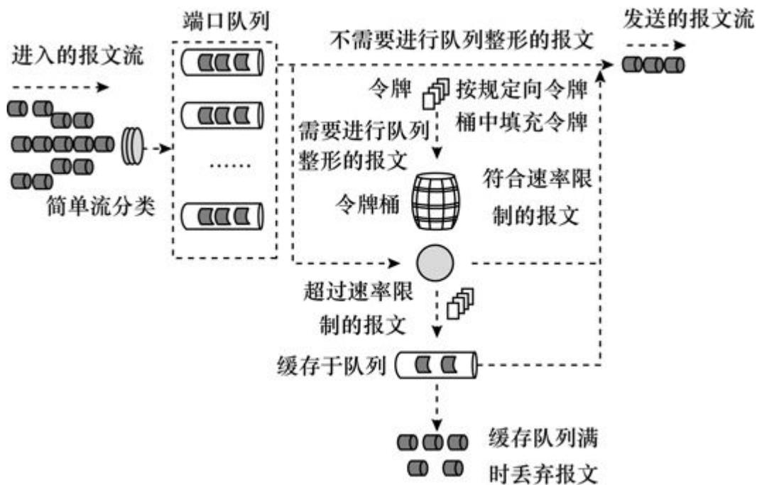
图10-10 流量整形处理流程图
