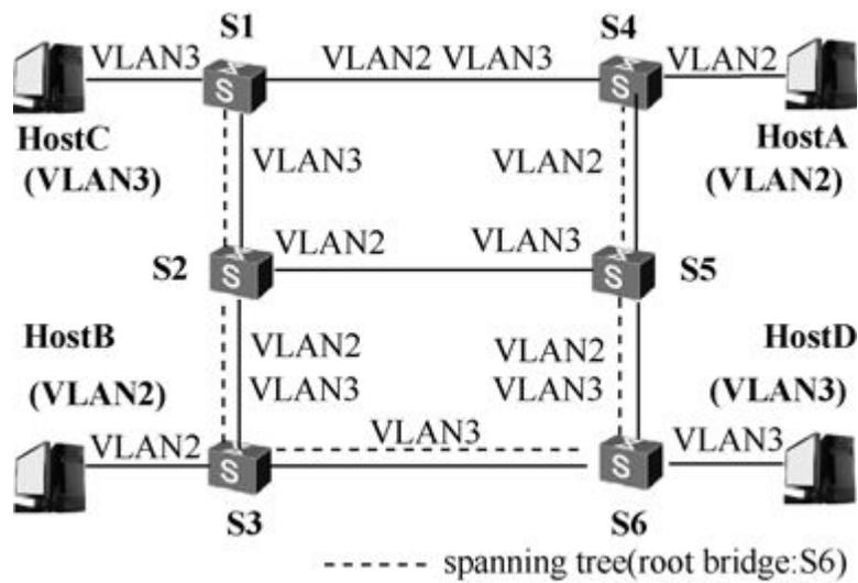
图8-24 采用STP/RSTP协议时的单生成树
