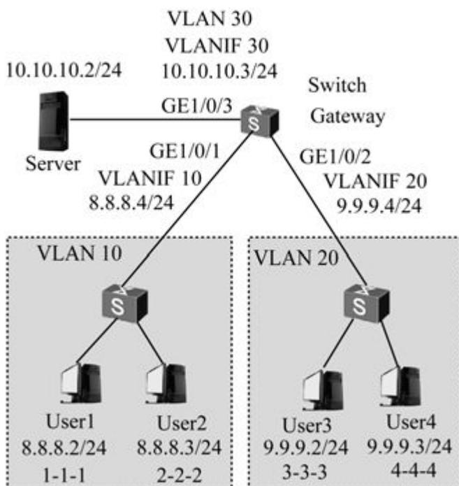
图16-1 ARP安全功能配置示例拓扑结构
