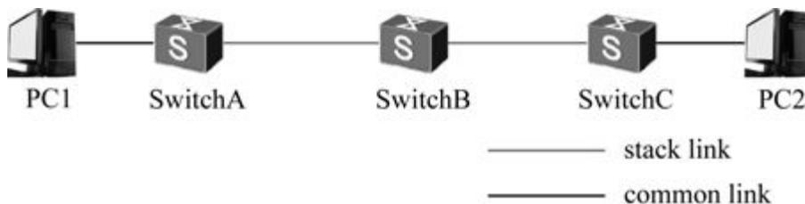
图5-5 iStack堆叠链形拓扑结构
