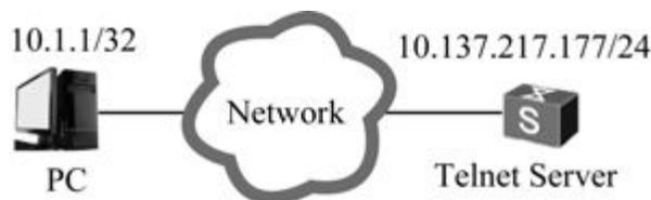
图3-9 通过Telnet登录交换机的配置示例拓扑结构
