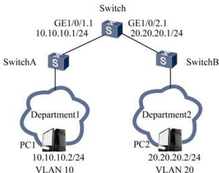
图6-24 通过子接口实现VLAN间通信的示例
