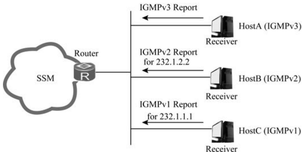
图12-14 SSM Mapping应用示例
