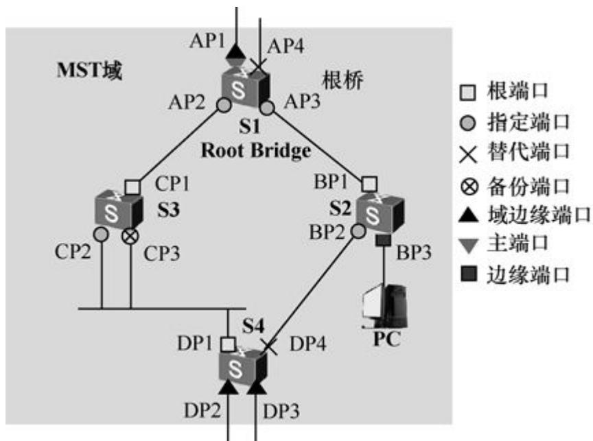
图8-32 MSTP端口示例
