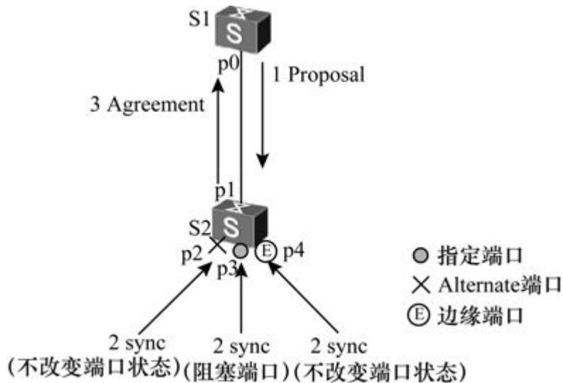
图8-21 P/A机制解析示例
