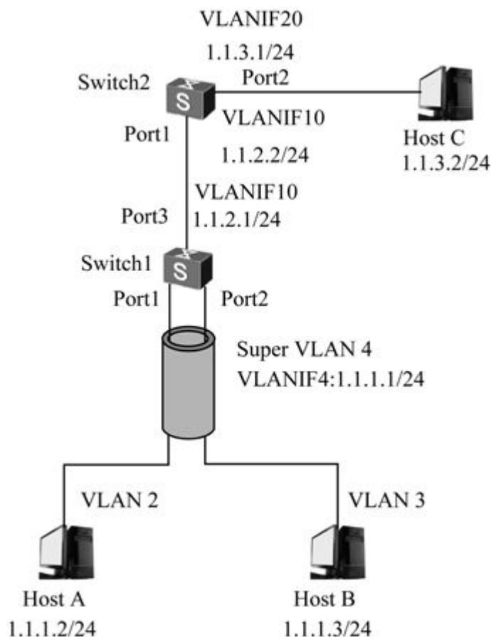
图7-6 Sub-VLAN与外部网络的三层通信示例
