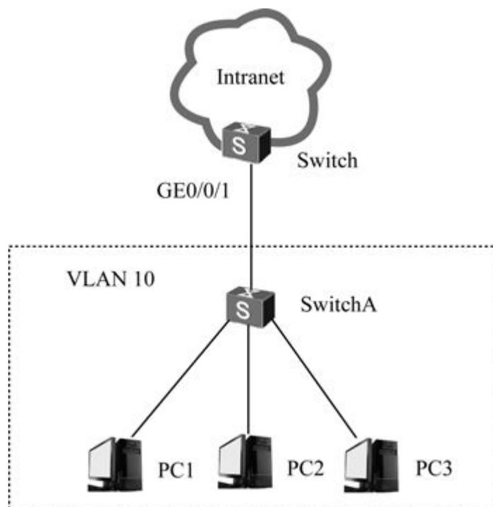
图15-3 端口安全配置示例拓扑结构
