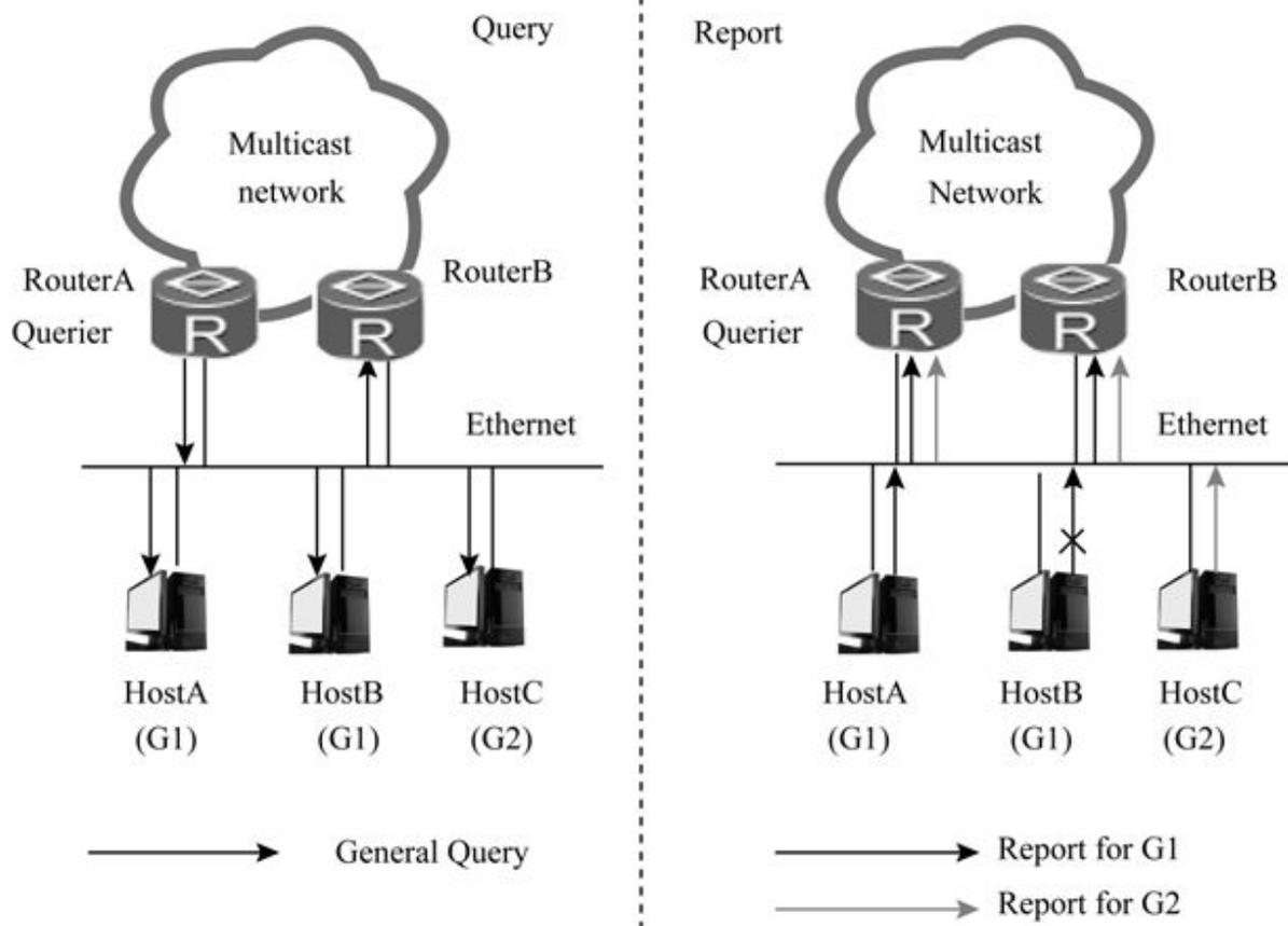
图12-9 普遍组查询和响应机制示意图
