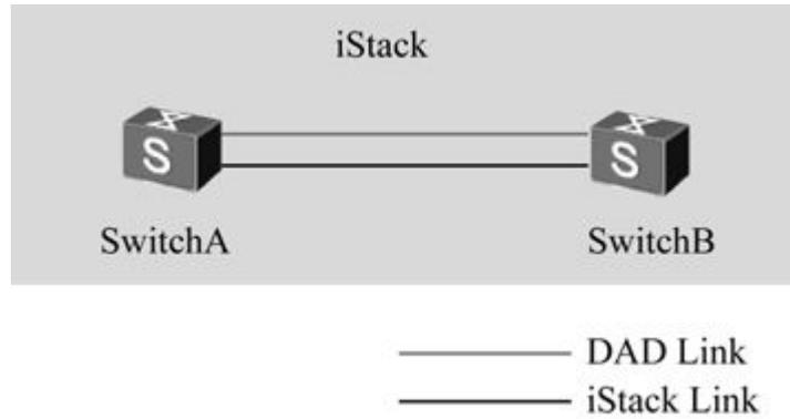
图5-7 直连方式双主检测示意图
