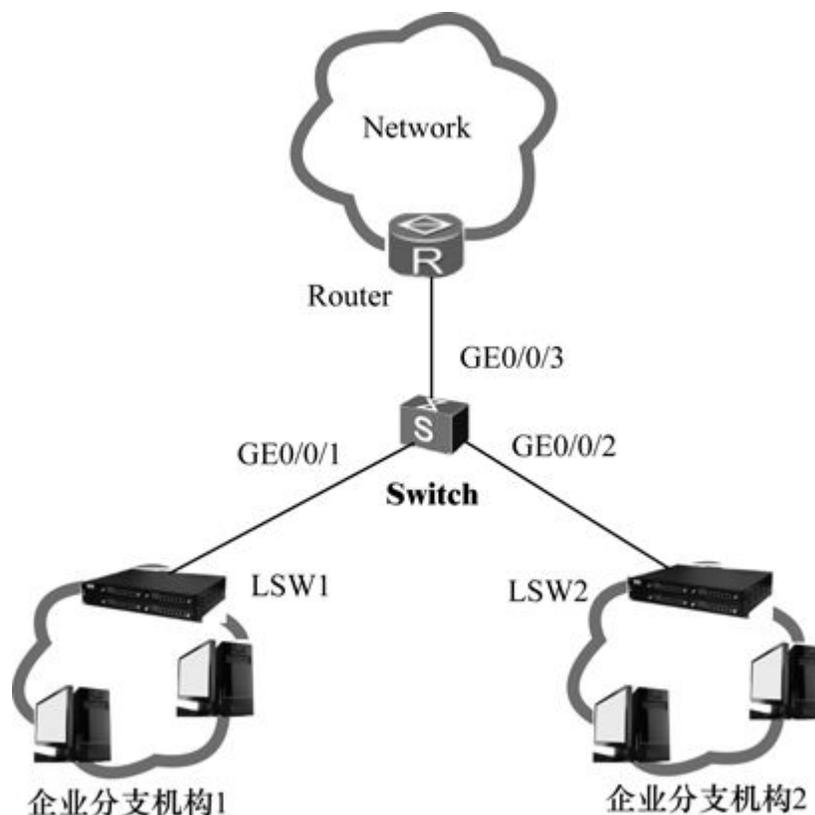
图11-3 基于接口的流量监管配置示例
