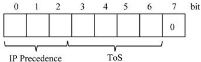
图10-2 IP包头中的ToS字段结构
