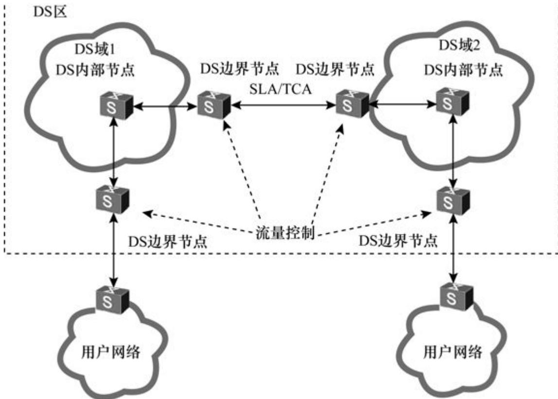
图10-4 DiffServ模型体系结构
