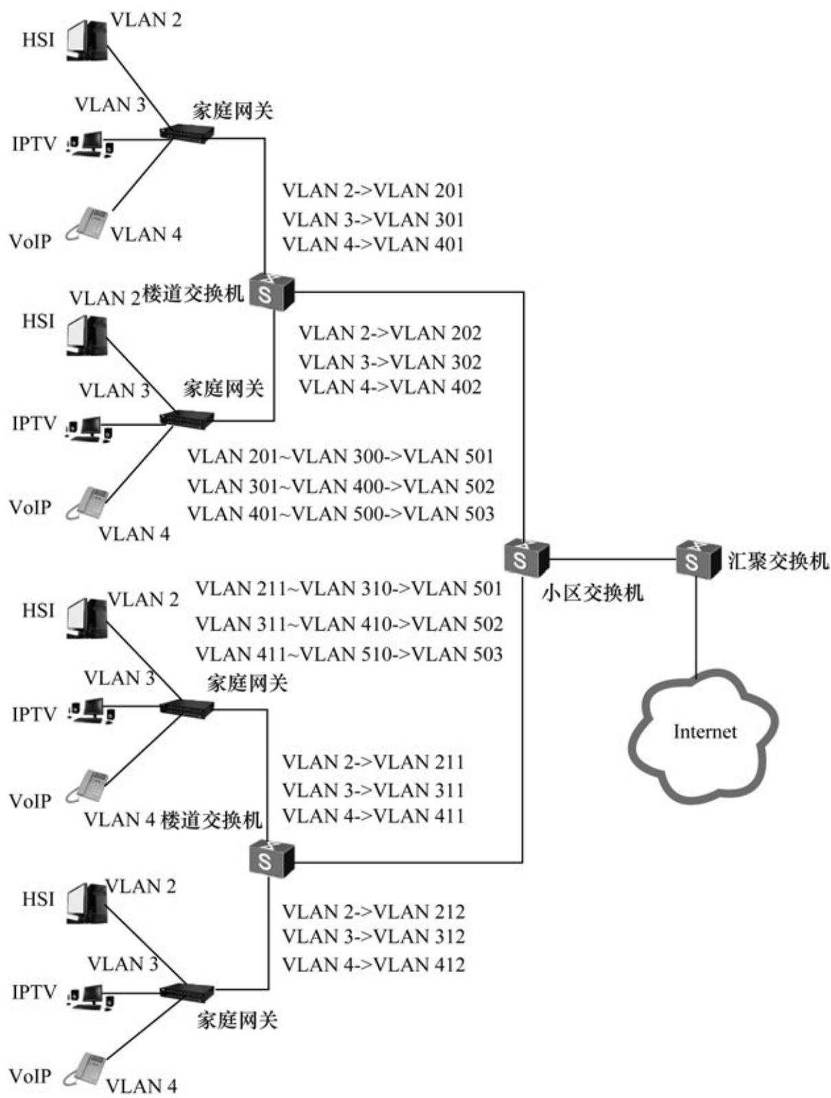
图7-20 1 to 1的VLAN映射应用示例
