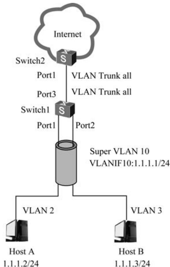
图7-5 Sub-VLAN与外部网络的二层通信示例
