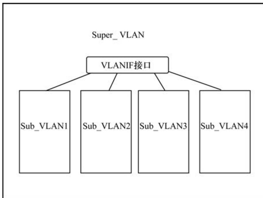
图7-2 Super-VLAN和Sub-VLAN的关系示意图
