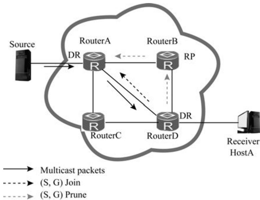
图12-22 组成员端DR触发SPT切换示例
