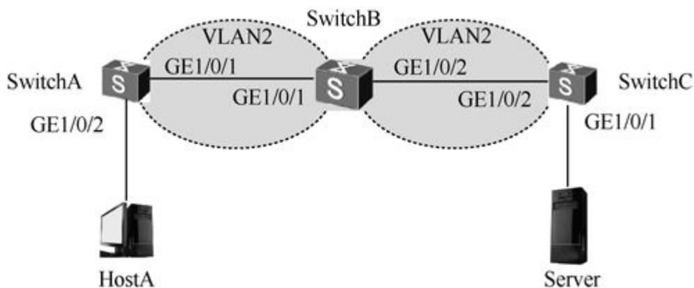
图14-9 二层远程端口镜像配置示例拓扑结构
