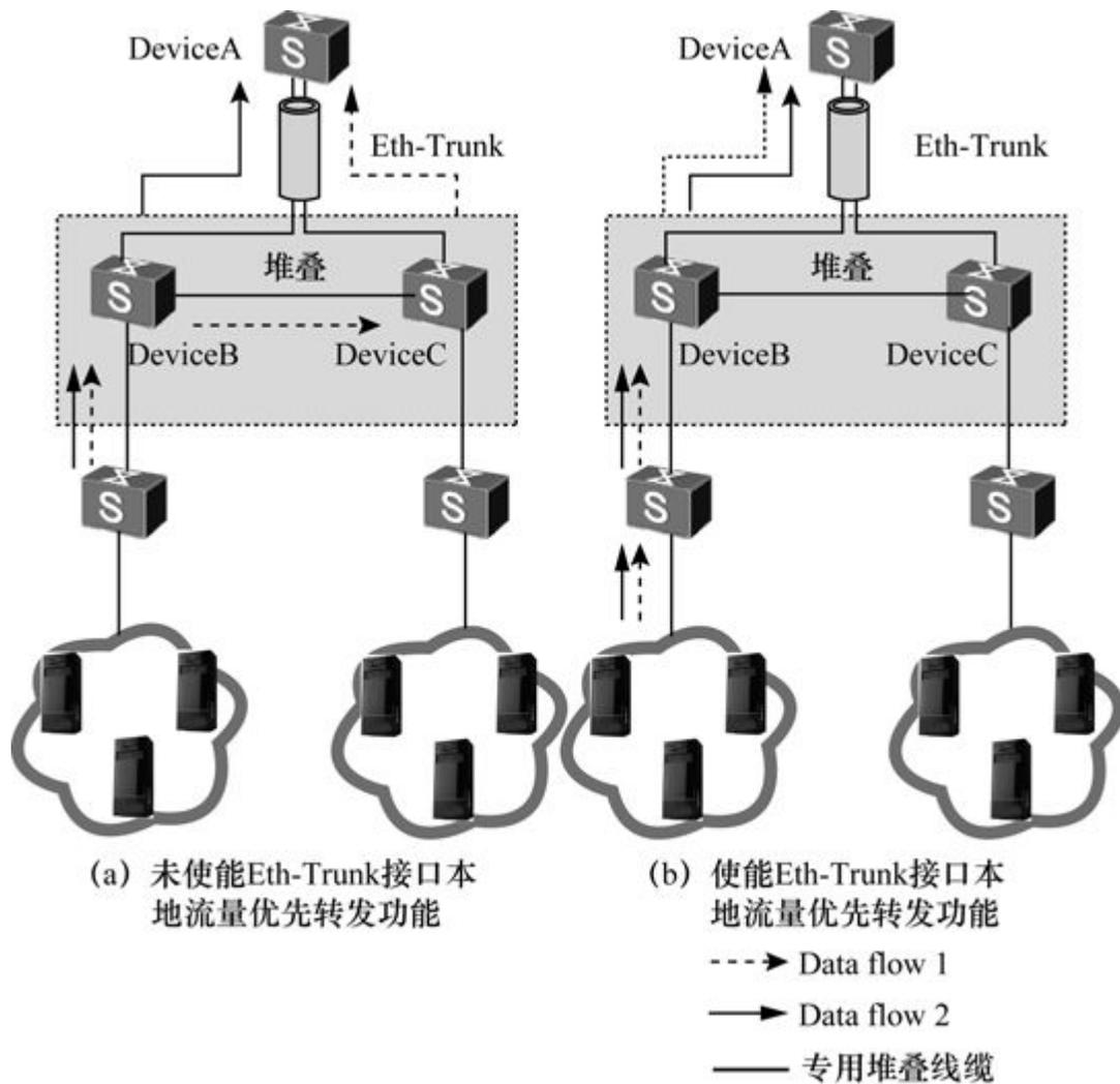
图4-5 Eth-Trunk接口本地流量优先转发示例
