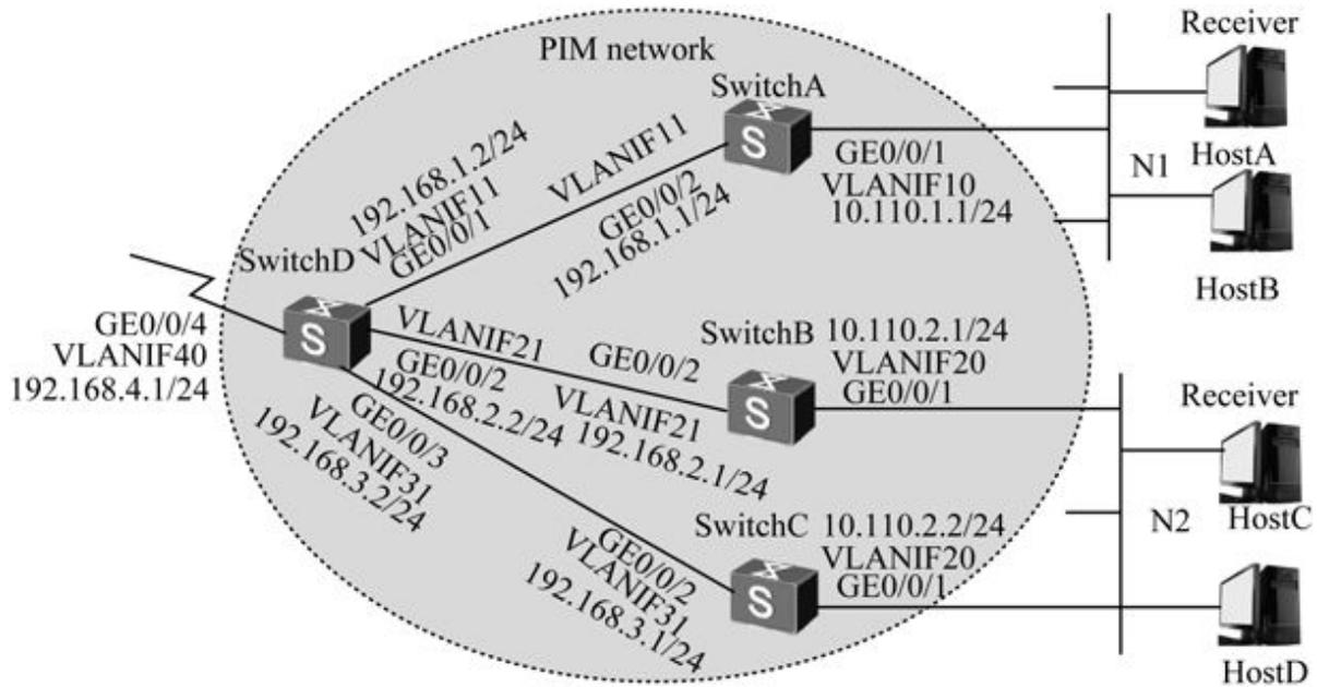
图13-1 IGMP的基本功能配置示例拓扑结构
