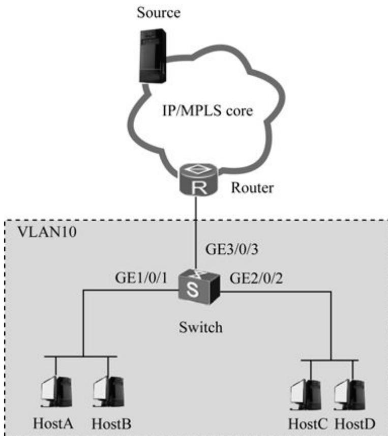
图13-11 静态端口配置示例拓扑结构
