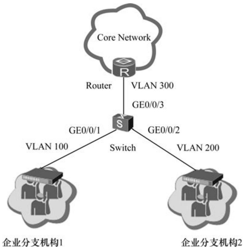
图11-2 优先级映射配置示例二拓扑结构
