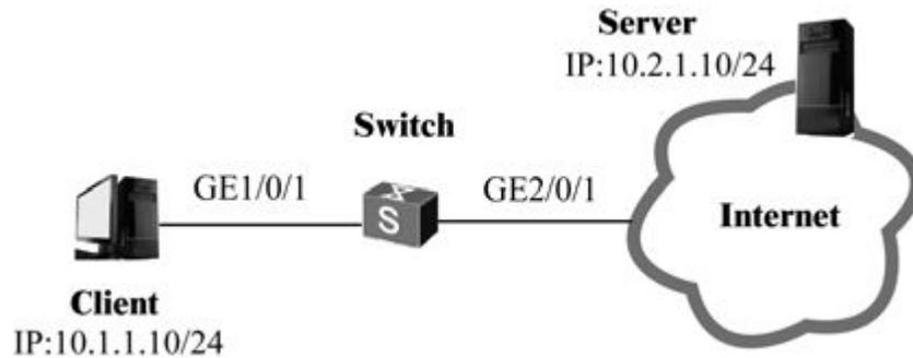
图9-6 自反ACL配置示例拓扑结构
