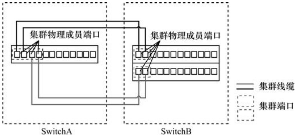
图5-17 错误的连接示意图
