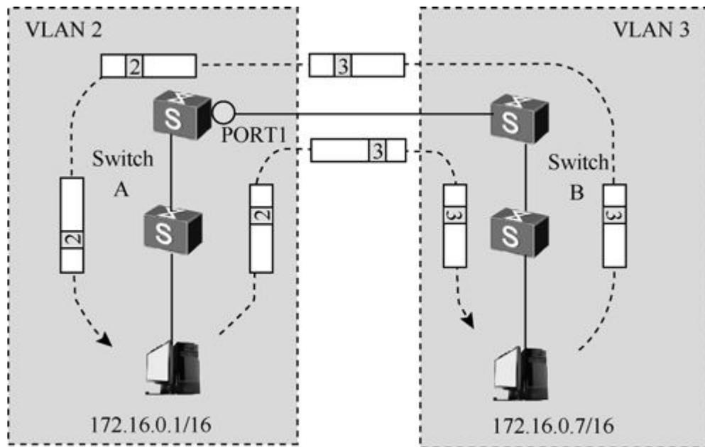
图7-19 VLAN映射应用示例
