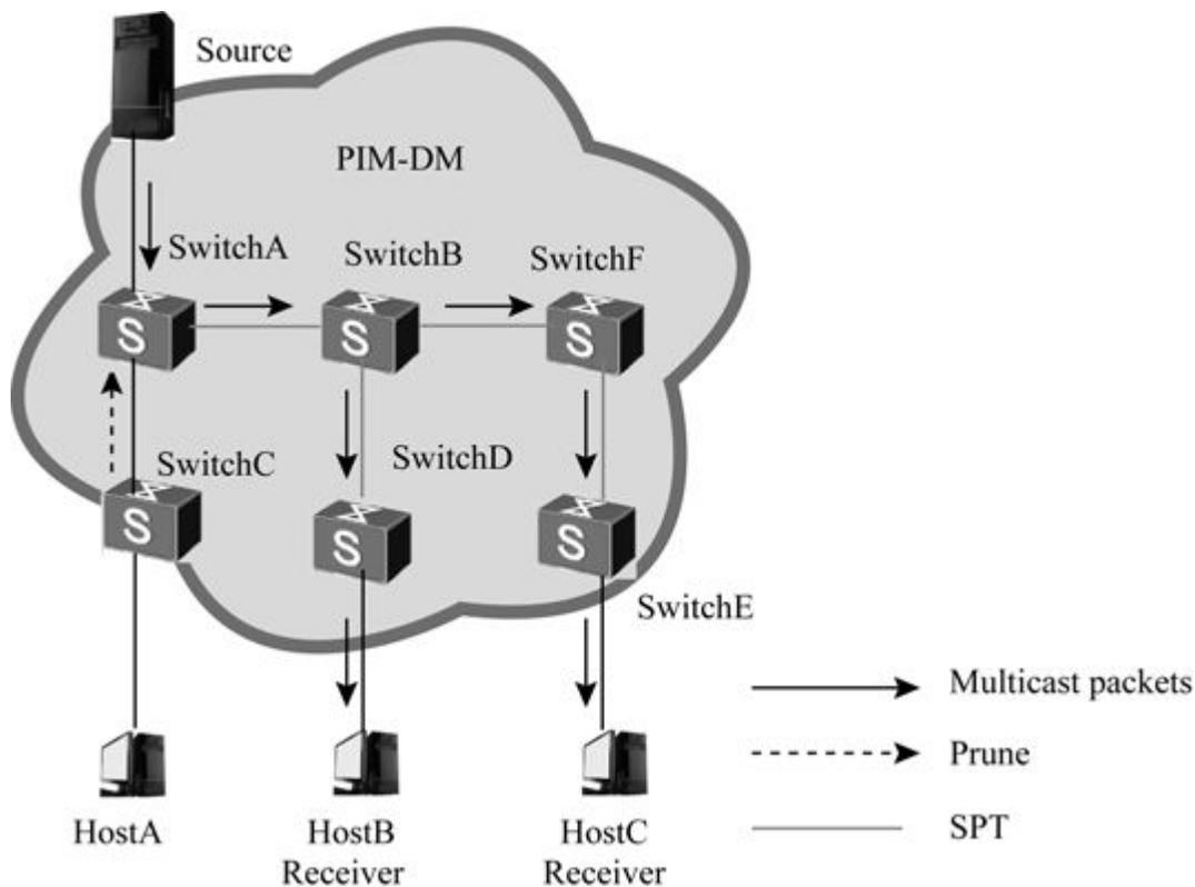
图13-4 PIM-DM网络构建SPT的示例
