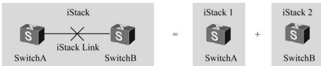
图5-6 堆叠分裂示意图
