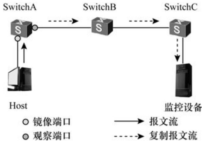
图14-5 二层远程端口镜像示意图
