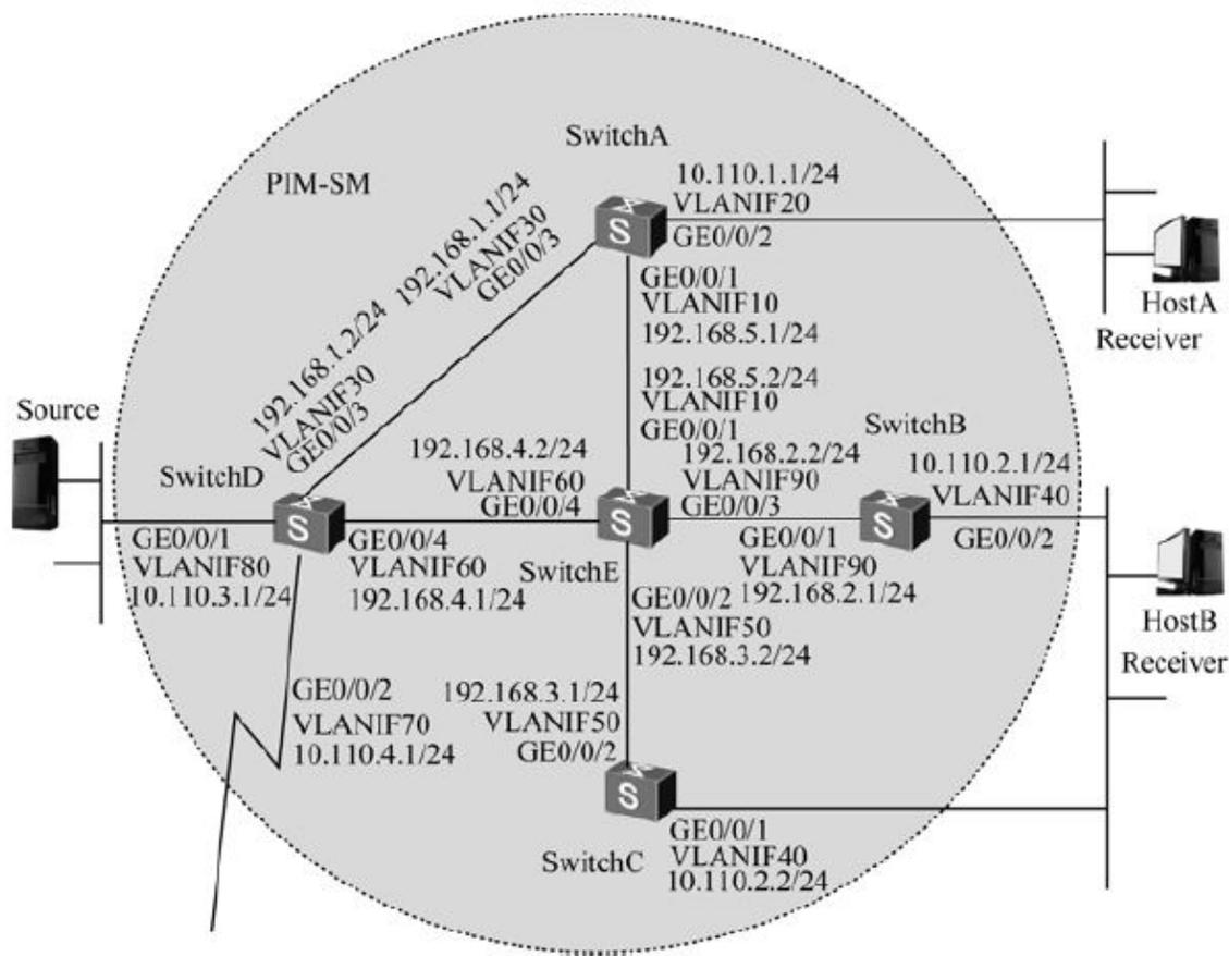
图13-8 ASM模型的PIM-SM域内组播配置示例
