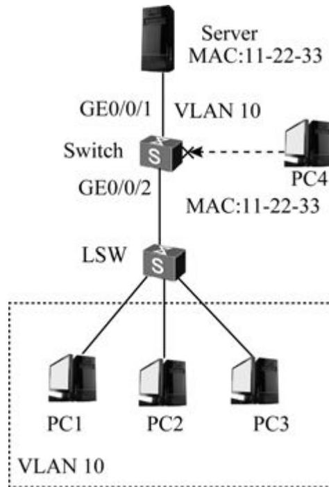
图15-4 MAC防漂移配置示例拓扑结构
