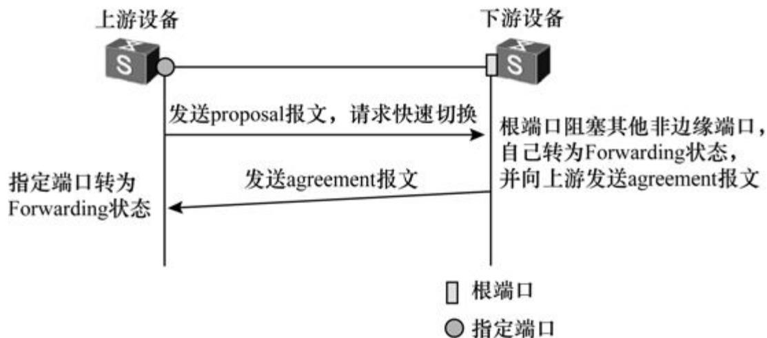
图8-20 P/A机制工作原理示意图
