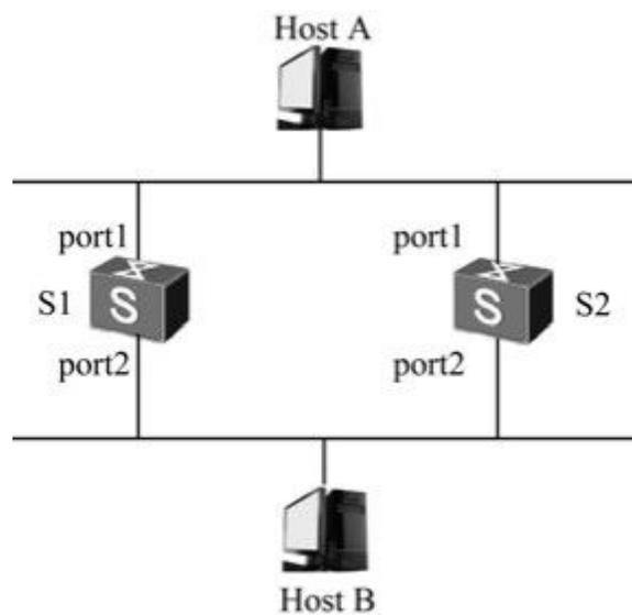
图8-3 环形结构网络示例
