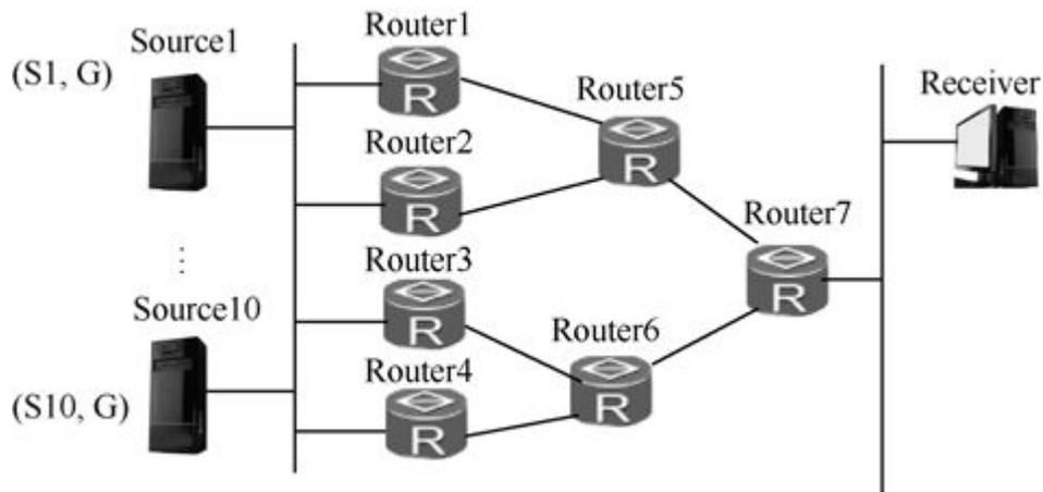
图12-49 基于组播源S的负载分担示意图
