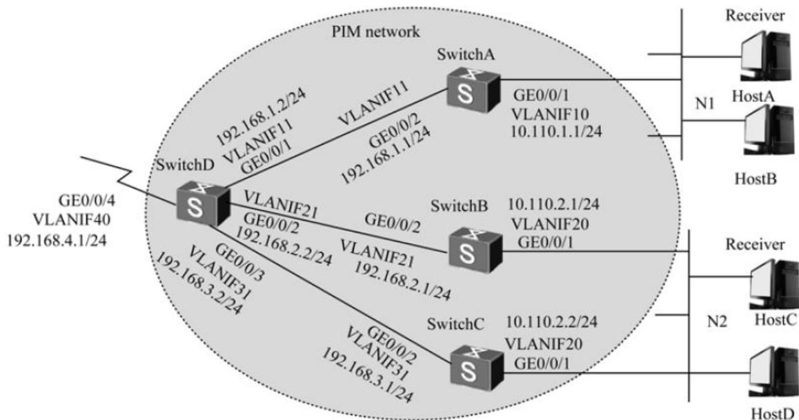
图13-2 静态加入组播配置示例拓扑结构
