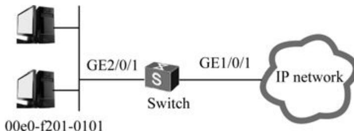
图9-3 二层ACL配置示例拓扑结构
