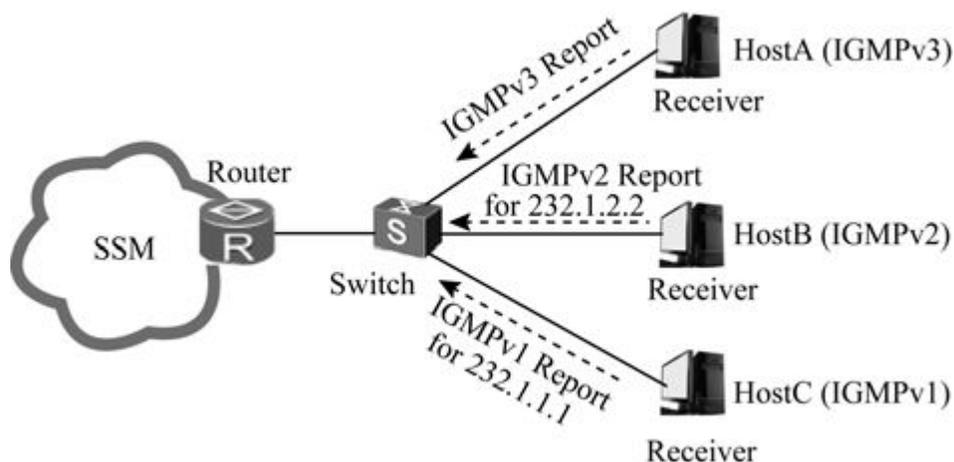
图12-40 二层组播SSM Mapping应用示例
