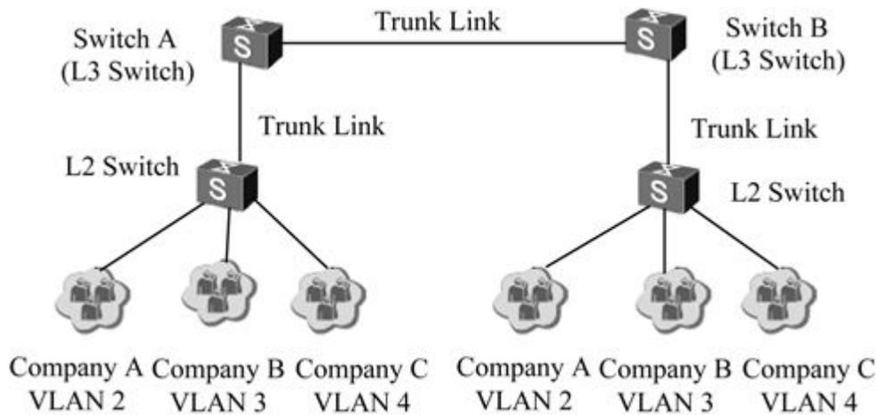
图6-19 跨三层交换机的VLAN间通信示例
