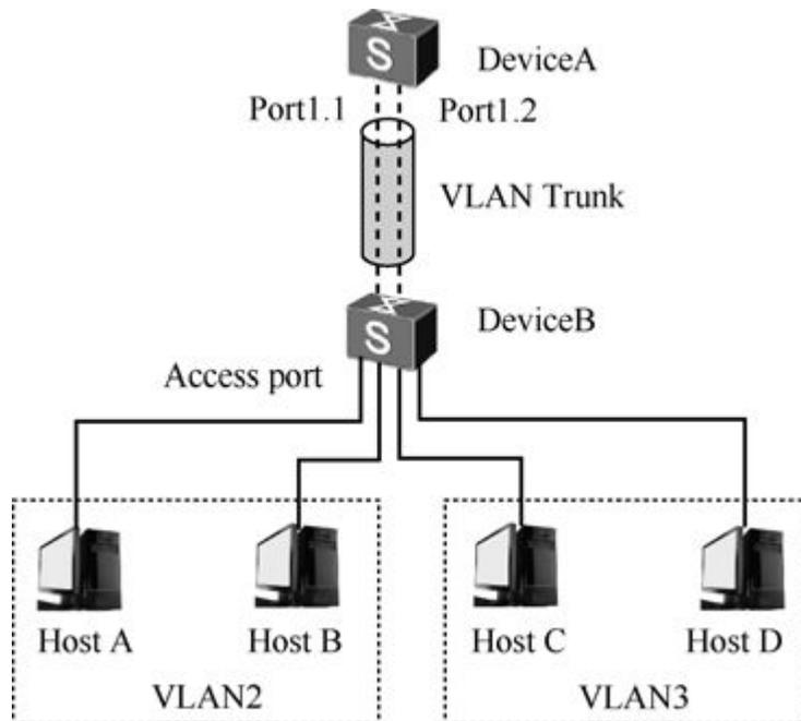
图6-21 通过子接口实现VLAN间通信的示例
