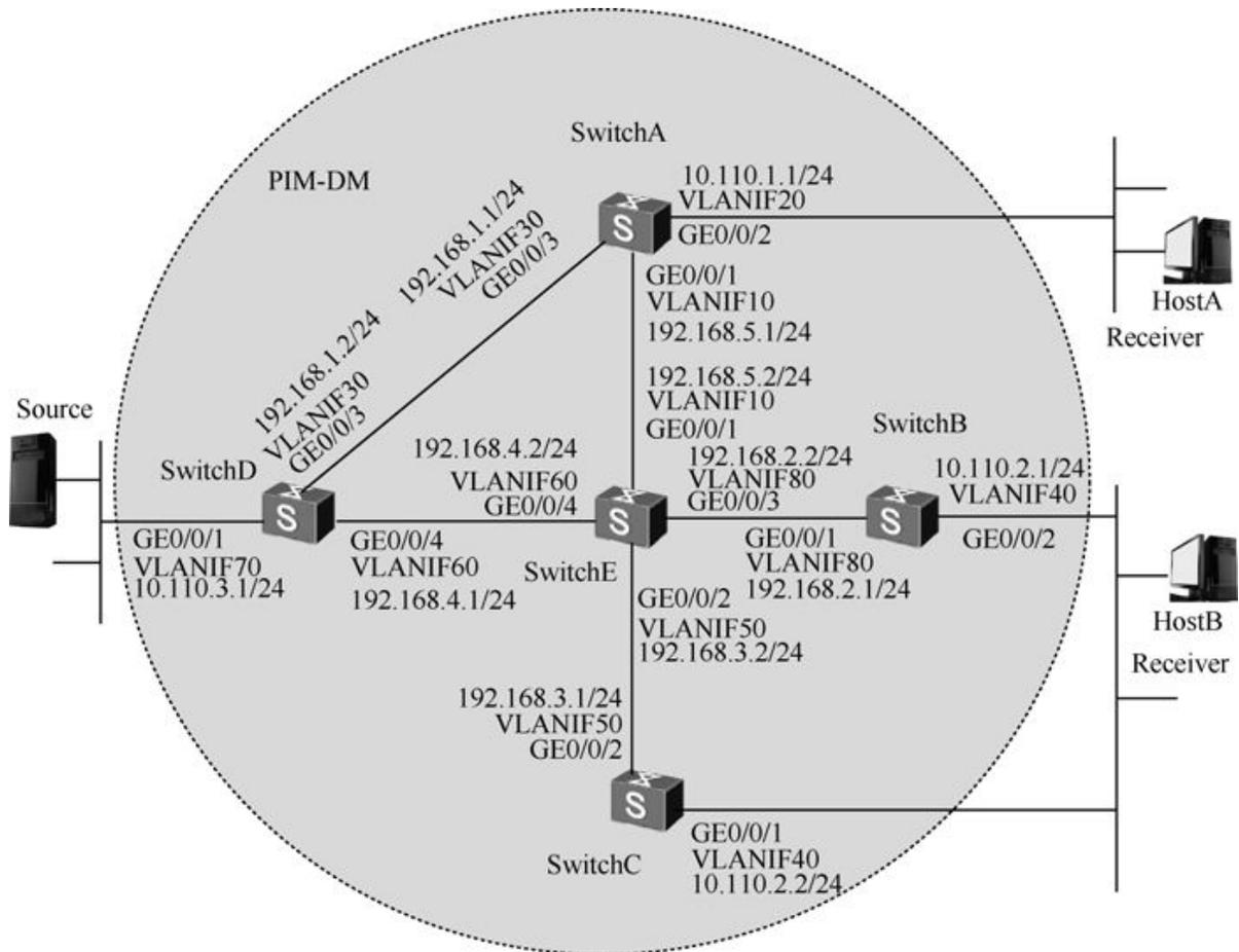
图13-5 PIM-DM基本功能配置示例拓扑结构
