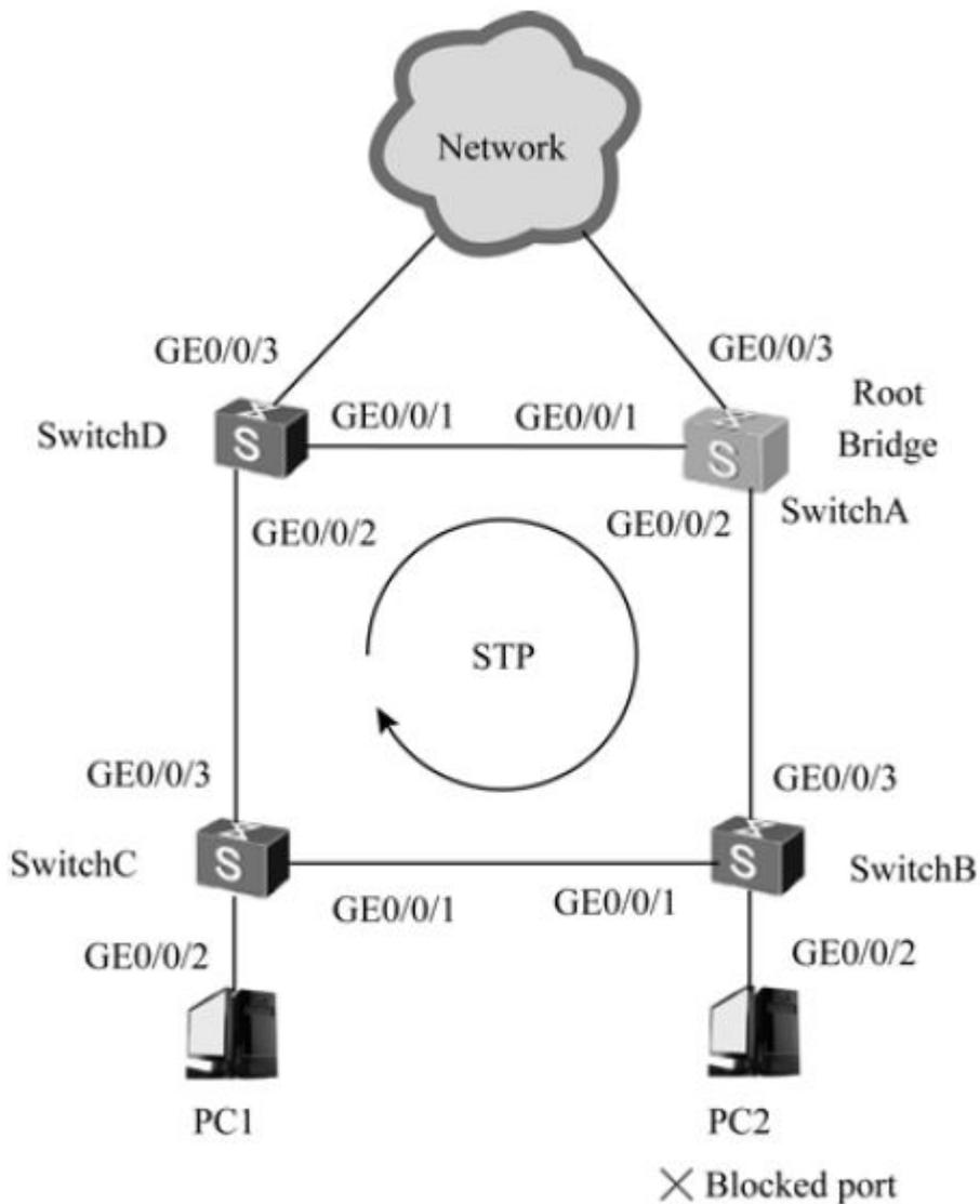
图8-23 STP配置示例拓扑结构
