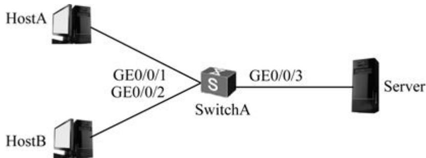
图14-12 本地VLAN镜像配置示例拓扑结构
