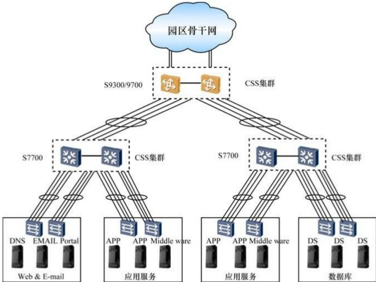
图1-23 S9300/9700系列交换机在大型数据中心核心层中的应用示例
