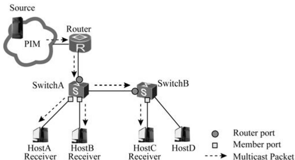
图12-38 IGMP Snooping相关端口角色
