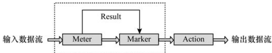
图10-8 流量监管基本工作机制示意图
