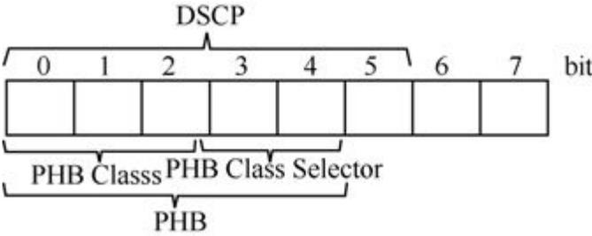
图10-3 IP包头中的DS字段结构
