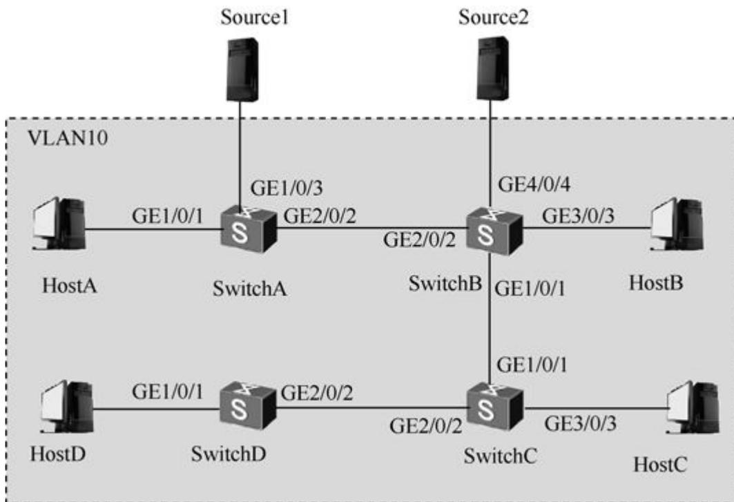
图13-12 IGMP Snooping查询器配置示例拓扑结构
