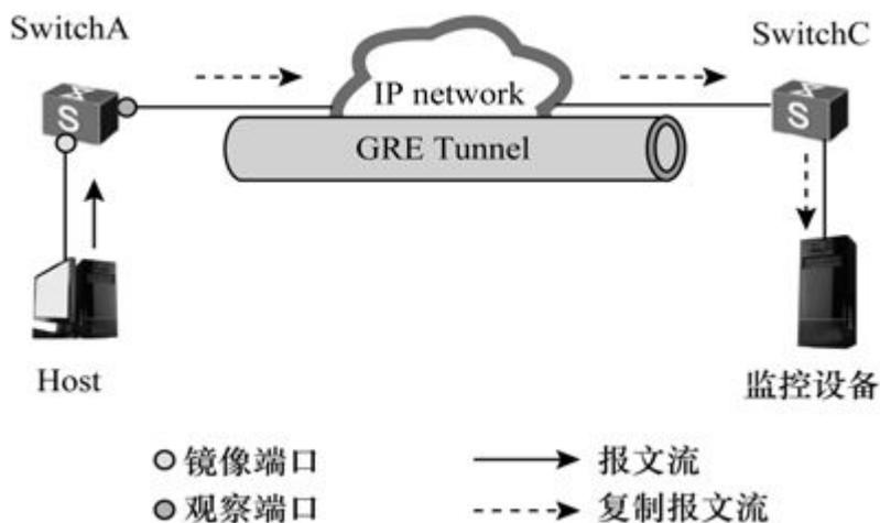
图14-6 三层远程端口镜像示意图
