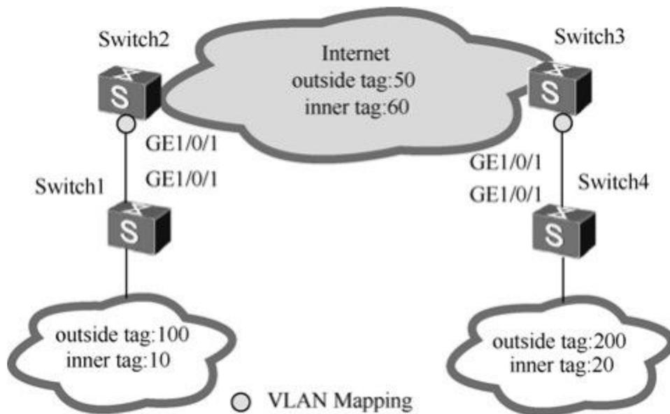
图7-22 2 to 2的VLAN映射应用示例
