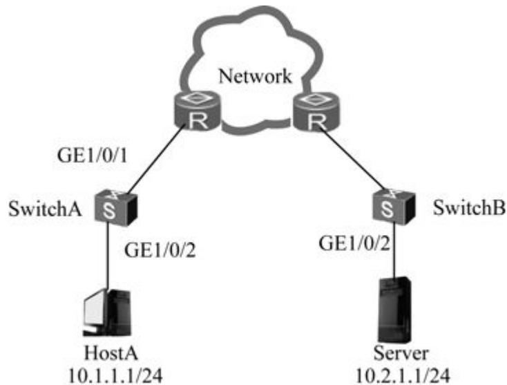
图14-10 三层远程端口镜像配置示例拓扑结构
