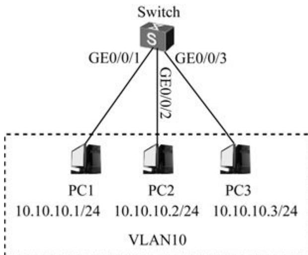
图4-2 端口隔离配置示例拓扑结构
