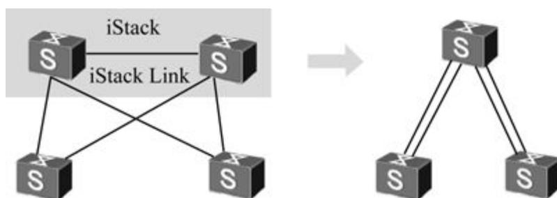
图5-1 iStack堆叠示意图
