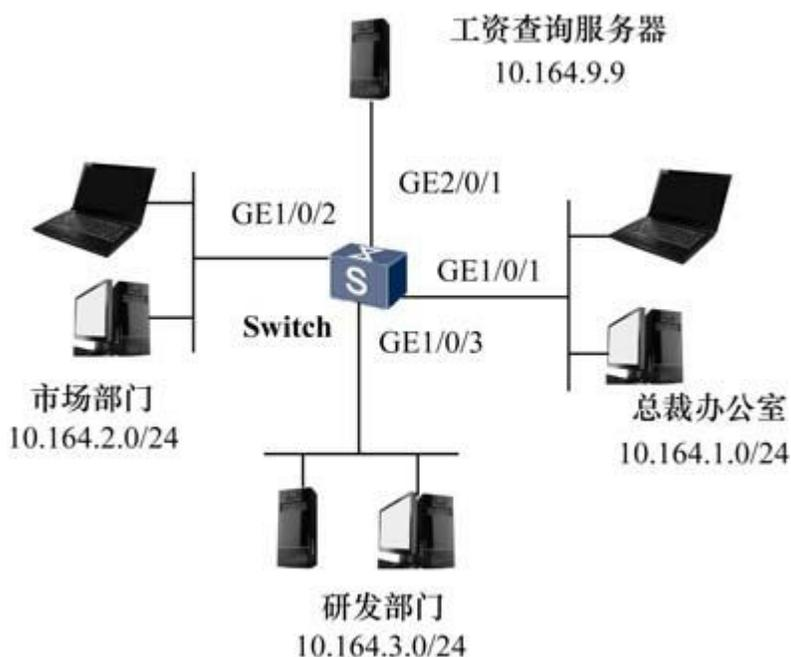
图9-2 高级ACL配置示例拓扑结构
