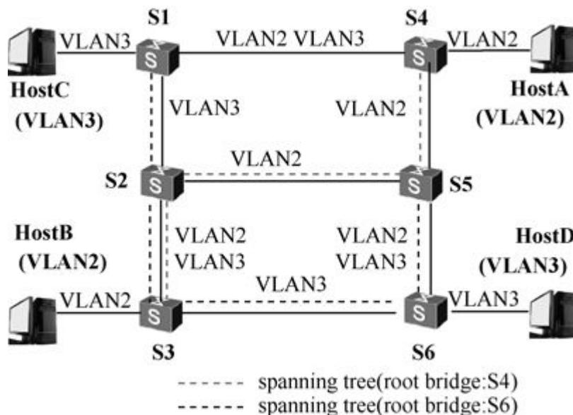
图8-25 采用MSTP协议后的两棵生成树
