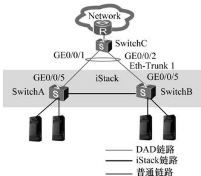
图5-12 Relay代理检测方式的DAD配置示例拓扑结构
