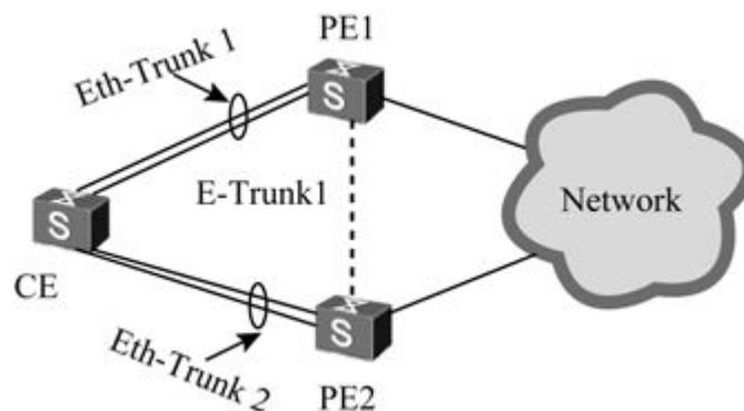
图4-6 E-Trunk组网示例
