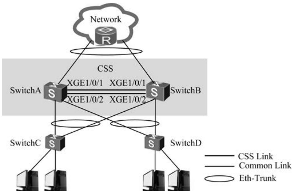
图5-22 业务口连接方式CSS集群配置示例拓扑结构
