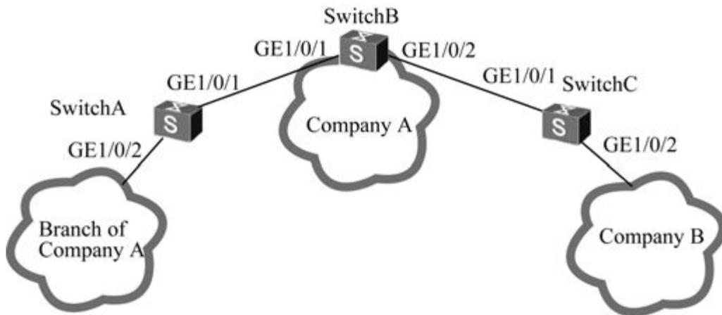
图6-17 GVRP配置示例拓扑结构
