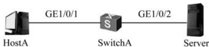
图14-8 本地端口镜像配置示例拓扑结构
