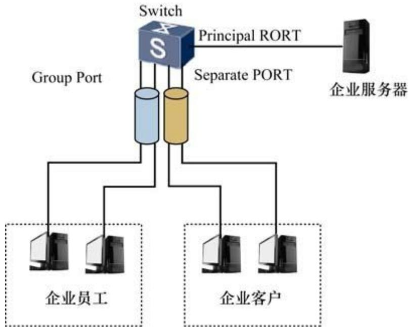
图7-9 MUX VLAN典型应用示例
