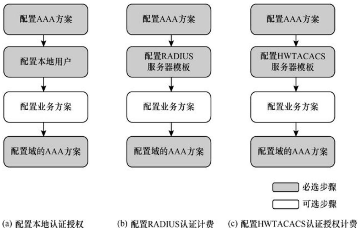
图17-3 三种AAA方案的配置流程
