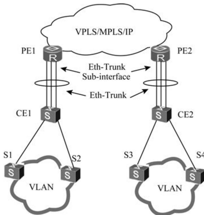
图4-10 Eth-Trunk子接口应用示例
