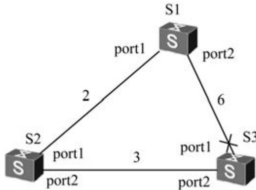
图8-18 对次优BPDU处理的示例图一
