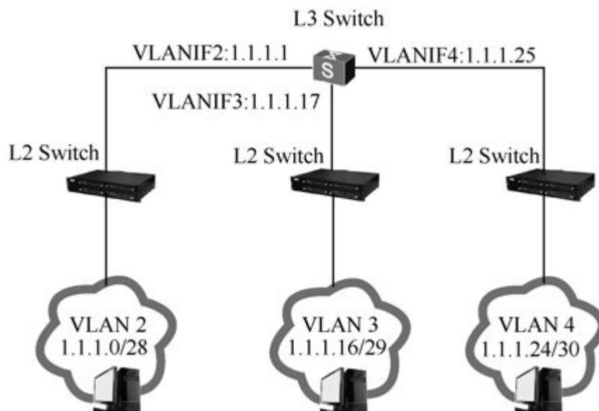
图7-1 普通VLAN配置方式的IP地址分配示例
